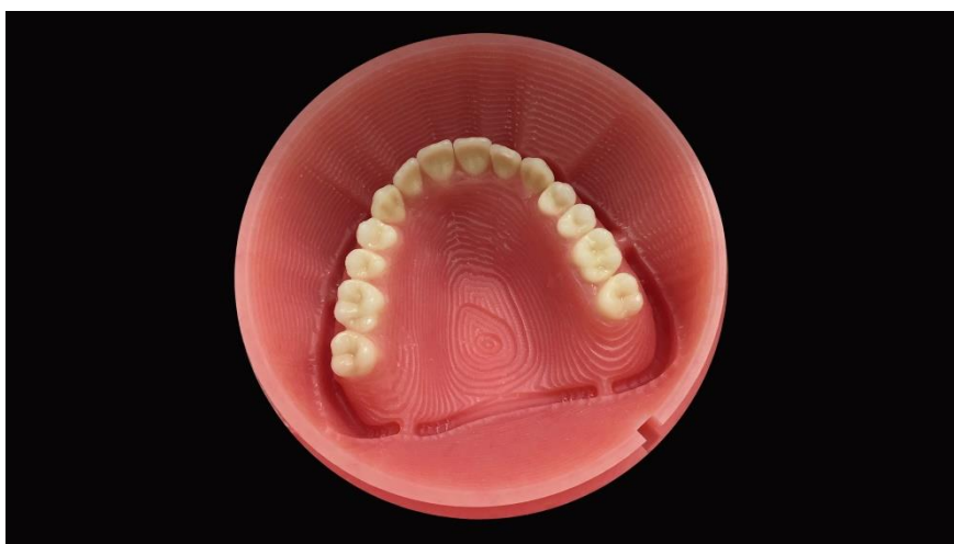
Fig. 1: Fabricación digital de prótesis con inLab MC X5 y el software inLab CAM 19.0: procesamiento de discos de hasta 35 mm de altura y fresado libre de base para prótesis que facilita el acceso a las bolsas periodontales al adherir los dientes.
